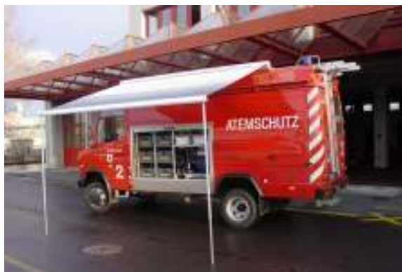
Stützen vertikal. Diese können bei Bedarf mit Heringen gesichert werden
