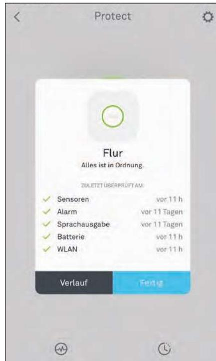
Smart Rauchmelder Nest Protect, mit Prüfprotokoll. Der Rauchmelder verfügt über sechs Sensoren.
